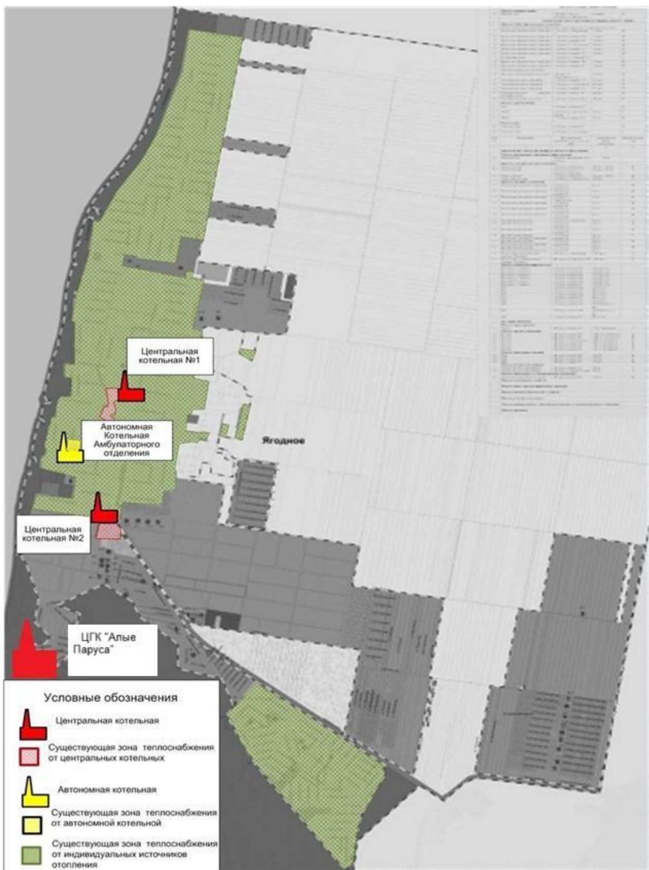
Рисунок 6 - Зоны действия централизованных и автономных котельных, а также индивидуальных источников тепловой энергии, находящихся в частной собственности жителей села Ягодное
